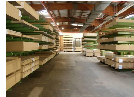
Sortenreine Lagerung durch Einsatz von Lagertechnik
