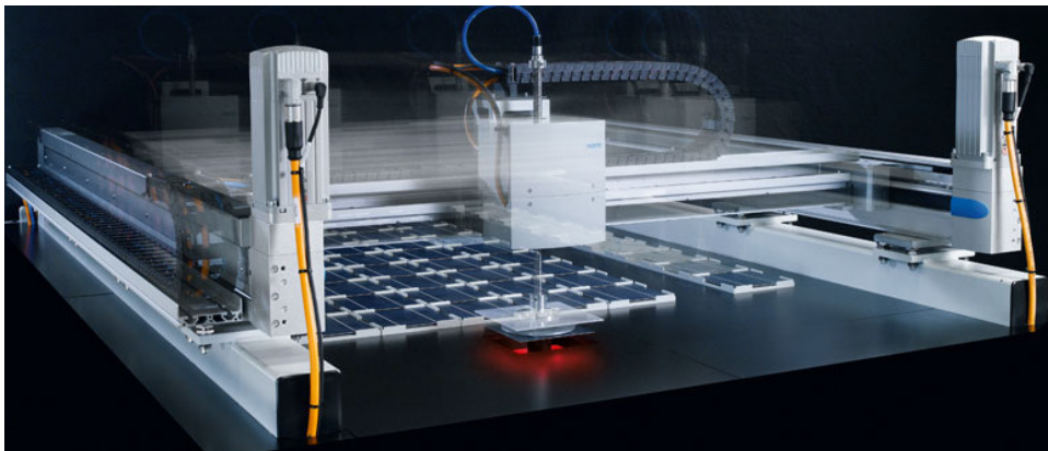
H-Portalsystem mit geringer bewegter Masse und feststehenden elektrischen Antrieben
