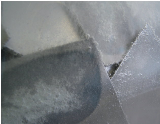
Zinkauflösung an der Oberfläche von Blechschrutt, Zinkreste (links), Entzinkte Oberfläche (rechts)
