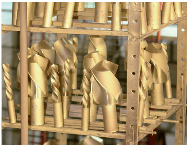
Rohstoff- und Kosteneinsparung bei nanobeschichteten Vollhartmetallstufenbohrern
