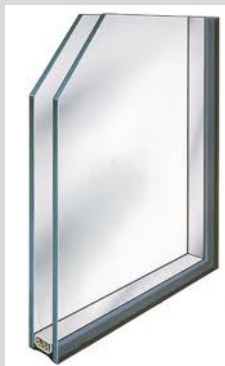
Aufbau eines Isolierglases
