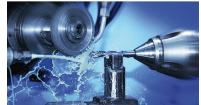
Neuer Kühlschmierstoff – ganz ohne Mineralöl – im Einsatz (Preisträger 2011: Fraunhofer-Institut für Verfahrenstechnik und Verpackung IVV)
