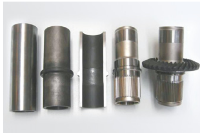
Effiziente Motorradachse: Neues Fertigungsverfahren spart 1,3 kg Roh(r)-material (Preisträger 2011: IFUTEK – Ingenieurbüro für Umformtechnik GmbH)
