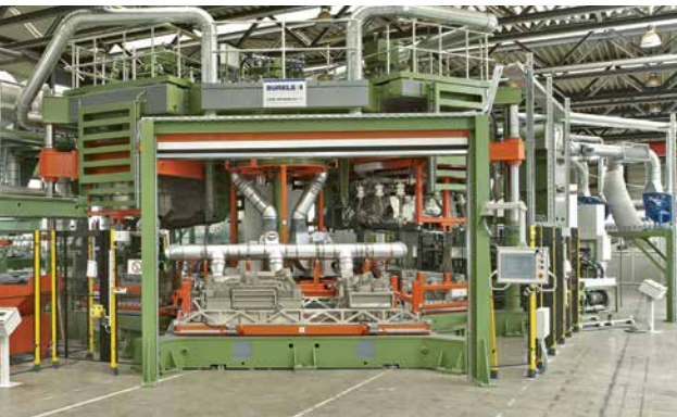
Serienanlage, auf der Faserformteile für ein Fahrzeug gefertigt werden.
