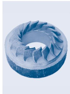
Der ForgeBrid – hergestellt durch die hybride Kombination der Fertigungsverfahren Freiformschmieden und Metall-3D-Druck
