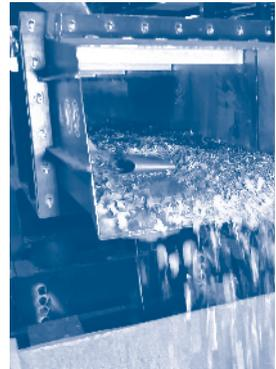
Entzinnte Kupfer-Stanzschrotte beim Austritt aus der Entzinnungsanlage
